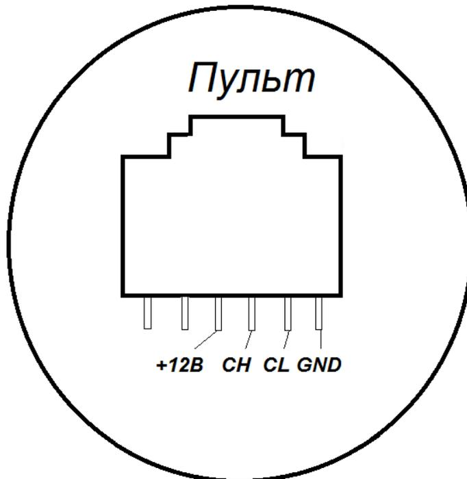
Рисунок 9 – Расположение проводов кабеля пульта управления.
