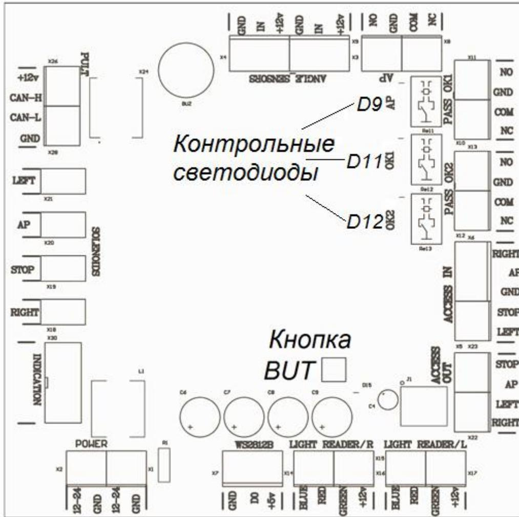
Рисунок 10 – Расположение контрольных светодиодов на материнской плате
