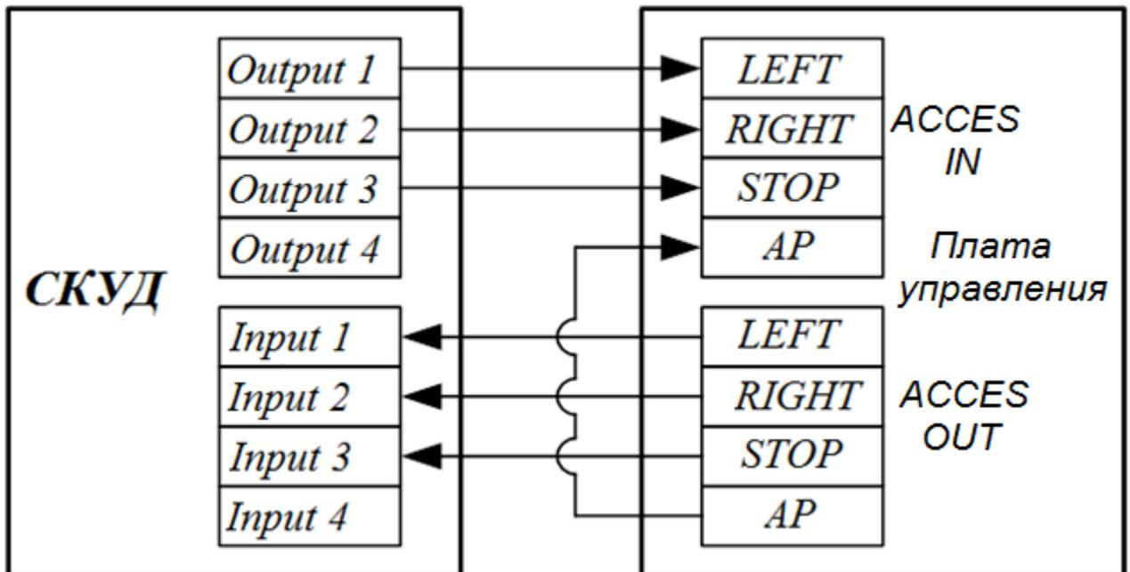
Рисунок 14 – Схема подключения ПУ к контроллеру СКУД
