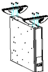
Прикрепите 4 ножки с помощью 8 болтов М5, идущих в комплекте.
