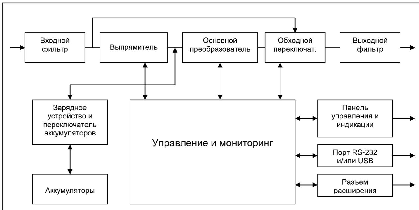
Рис. 7. Блок-схема ИБП
