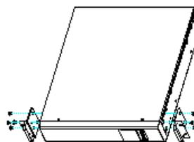
Прикрепите 2 «ушек» с помощью 8 болтов М5, идущих в комплекте.
